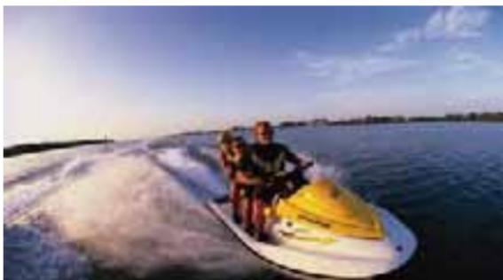
Las motoras acuáticas son vehículos con motores dentro de borda impulsadas por un motor de propulsión a chorro y diseñadas para llevar de una a cuatro personas. Antes de entrar a aguas abiertas, conozca bien las características operacionales de la motora acuática.
